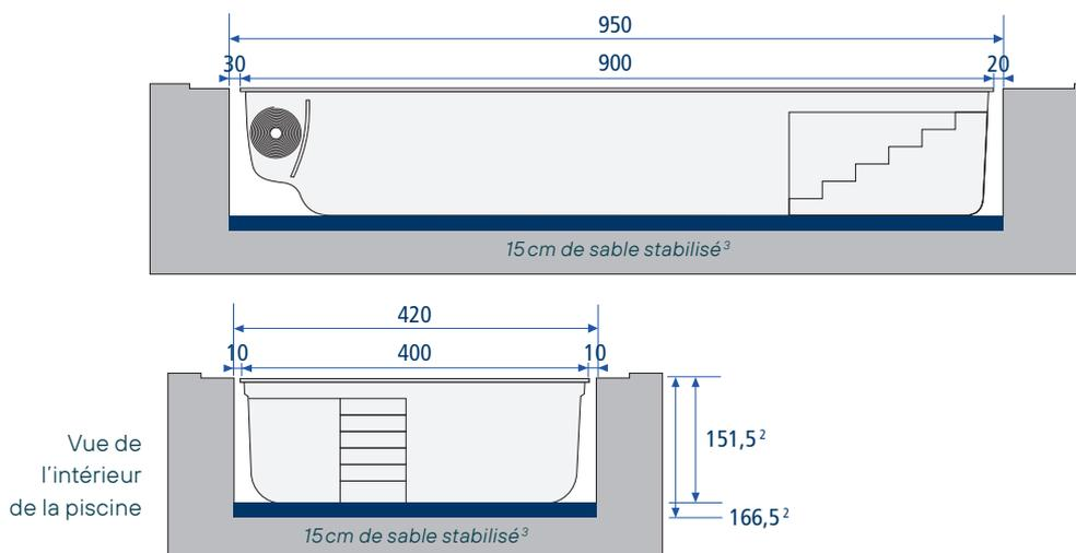
Attention : les mesures de terrassement ne tiennent pas compte des décaissements nécessaires aux margelles.
