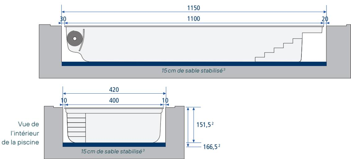
Attention : les mesures de terrassement ne tiennent pas compte des décaissements nécessaires aux margelles.
