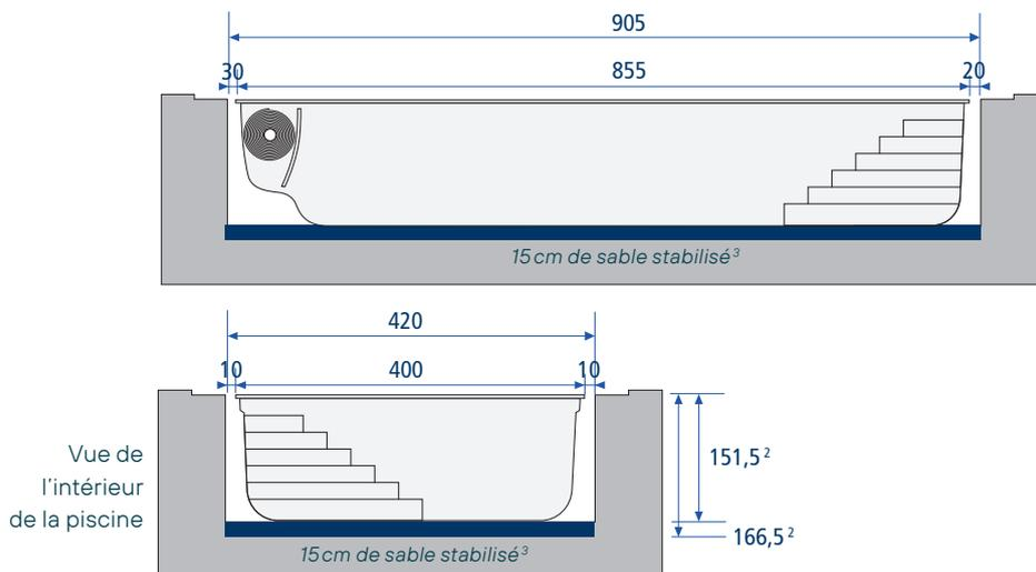
Attention : les mesures de terrassement ne tiennent pas compte des décaissements nécessaires aux margelles.
