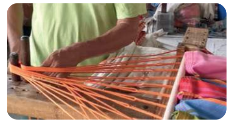
Cordage : fabrication du cordage et de la boucle de fixation
