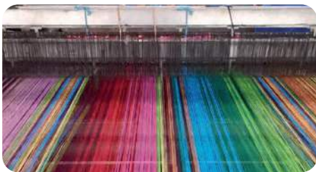
Tissage : installation des fils à la main puis tissage au métier à tisser
