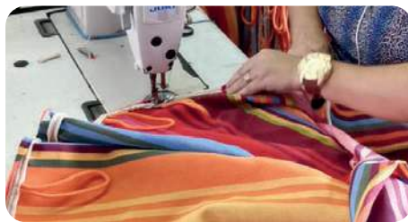
Coutures : quadruples coutures avec renforcement sur triple toile + fixation des boucles
