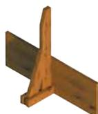
**En L** : avec renforts fixés dans la dalle et goujons d'ancrage
