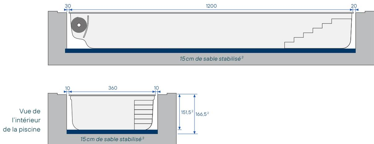
Attention : les mesures de terrassement ne tiennent pas compte des décaissements nécessaires aux margelles.
