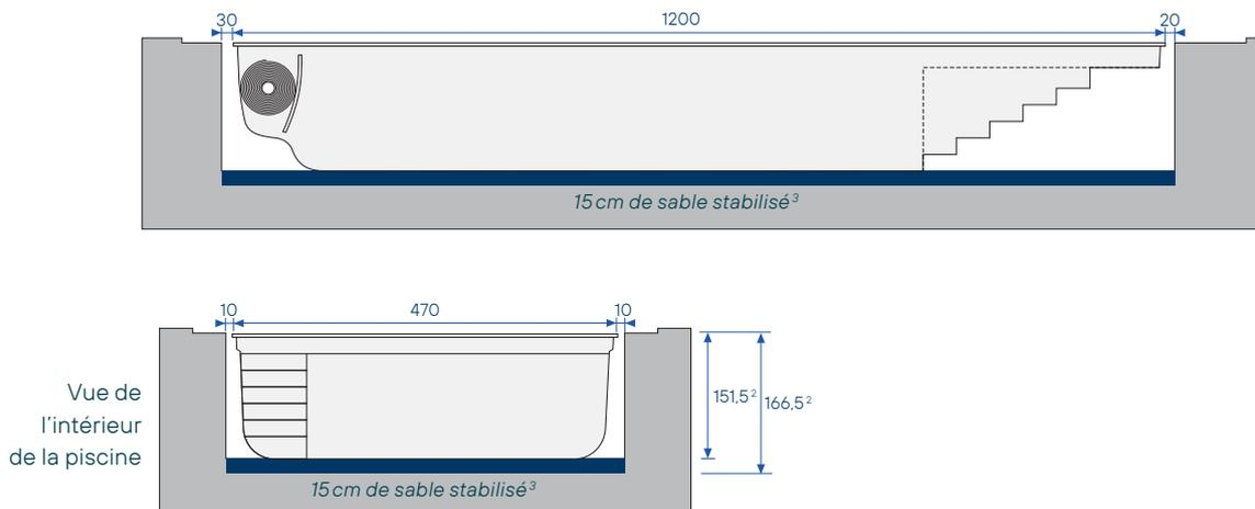
Attention : les mesures de terrassement ne tiennent pas compte des décaissements nécessaires aux margelles.
